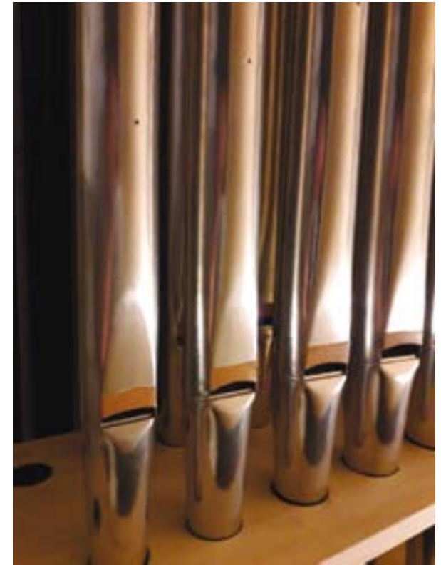
Hüsten St. Petri Soloflöte 8' mit belederten Oberlabien 2018 Rieger-Organbau
